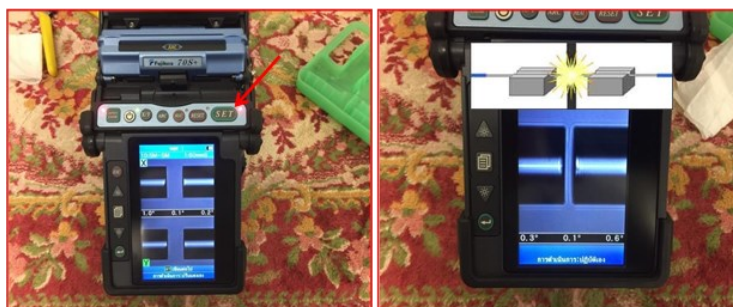
รูปที่ 35 กดปุ่มเชื่อมต่อ (Set)
