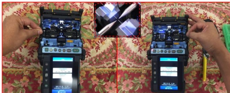
รูปที่ 34 วางลงในเครื่องเชื่อมต่อแกนใยแก้วนำแสง
