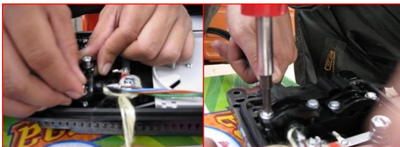
รูปที่ 25 ใส่ตัวประกอบเพื่อล็อกสายเคเบิล
