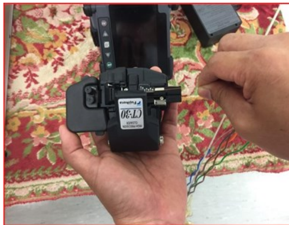
รูปที่ 33 ใช้อุปกรณ์ตัด (Clever)
